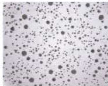
Fig2 Ductile cast iron microstructure البنية المجهرية للزهر المرن
