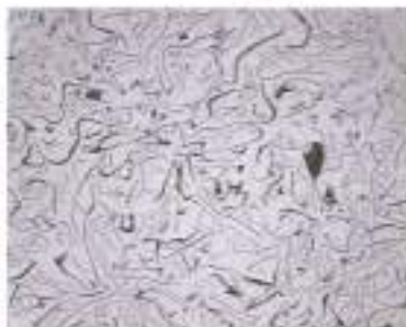
Fig1 Grey cast iron micro structure البنية المجهرية للزهر الرمادي
